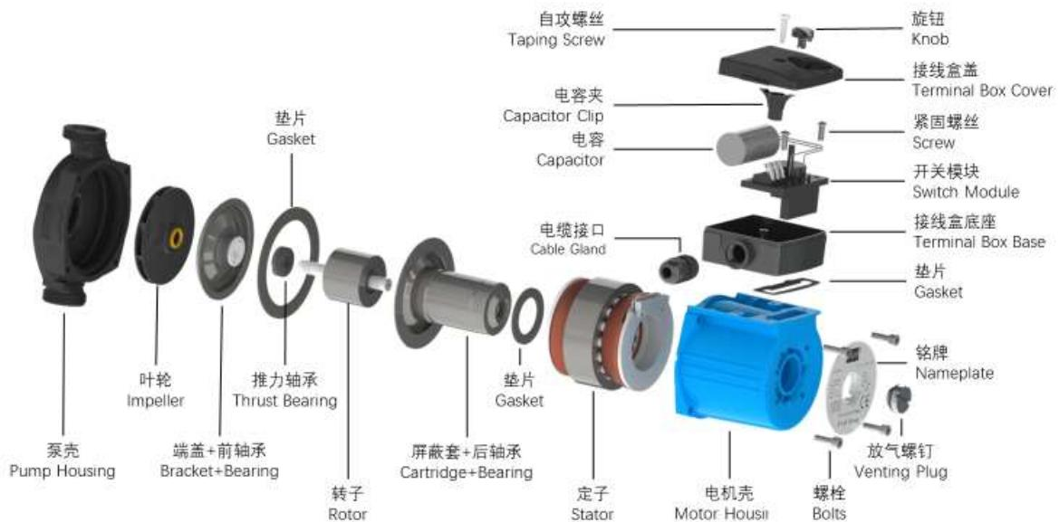
DS系列水泵属于屏蔽湿转子泵，水泵与电机形成一个整体结构，水泵叶轮和电机转子通过屏蔽套筒密封并与电机定子绕组隔离，不使用机械密封，只采用两个密封垫圈密封。轴承由水泵输送的液体润滑，电机由水泵输送的液体冷却。不泄漏和低噪音是屏蔽湿转子泵的两大特点。
